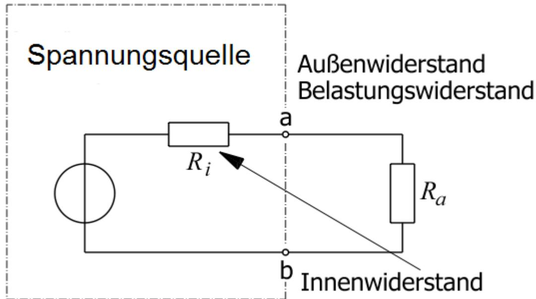
Entnimmt man einer Spannungsquelle Strom, so sinkt die **Leerlaufspannung** um einen bestimmten Wert, welcher von **Innenwiderstand** abhängig ist. Der Innenwiderstand ergibt sich aus den Eigenschaften der Spannungsquelle.
