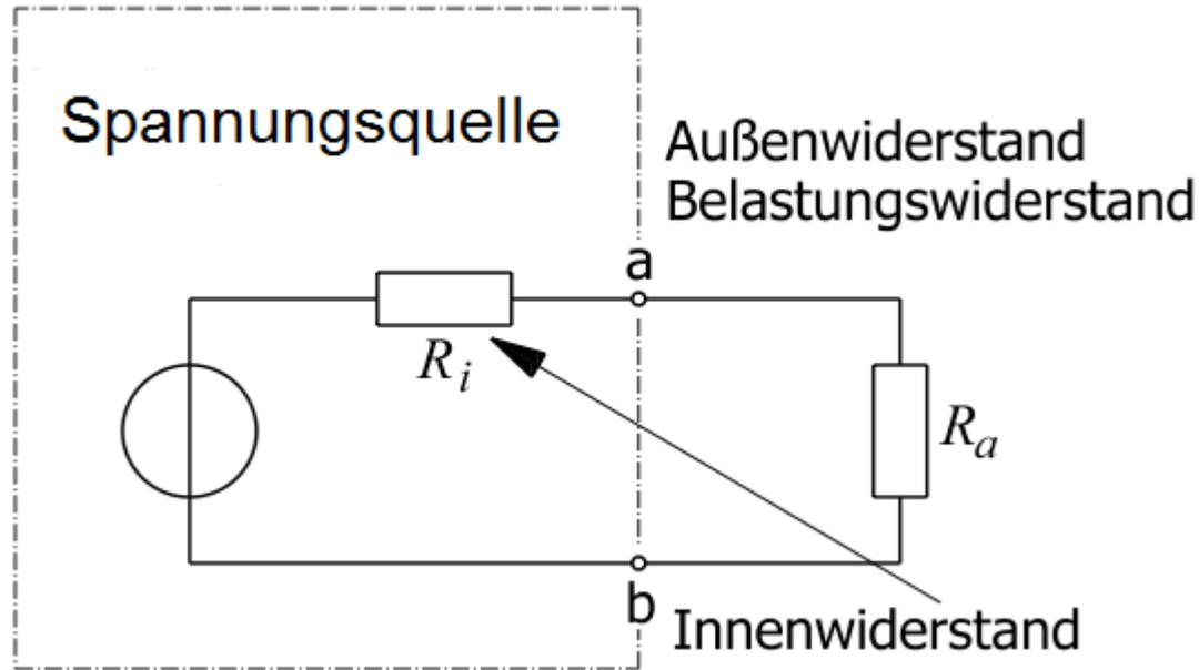
Die **Klemmenspannung** (zwischen a und b) sinkt also ab, weil an  $R_i$  eine Spannung abfällt.
